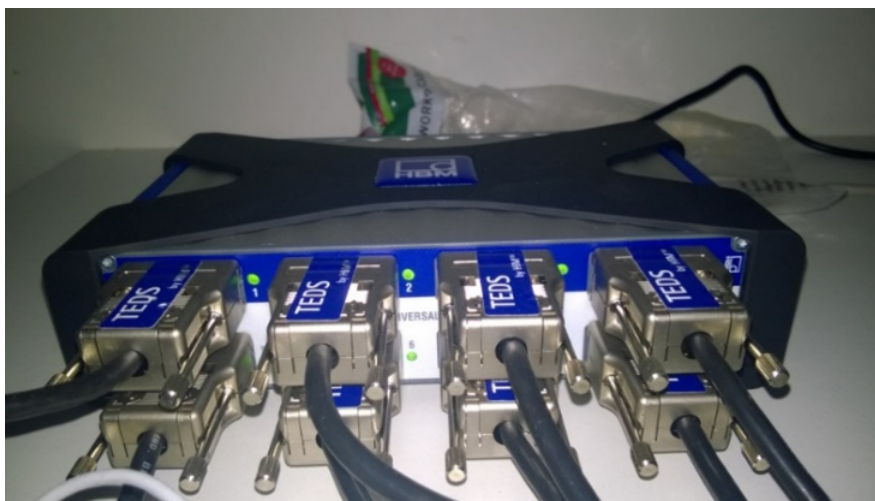
Figura 4: Sistema de aquisição de dados HBM QuantumX MX840A
