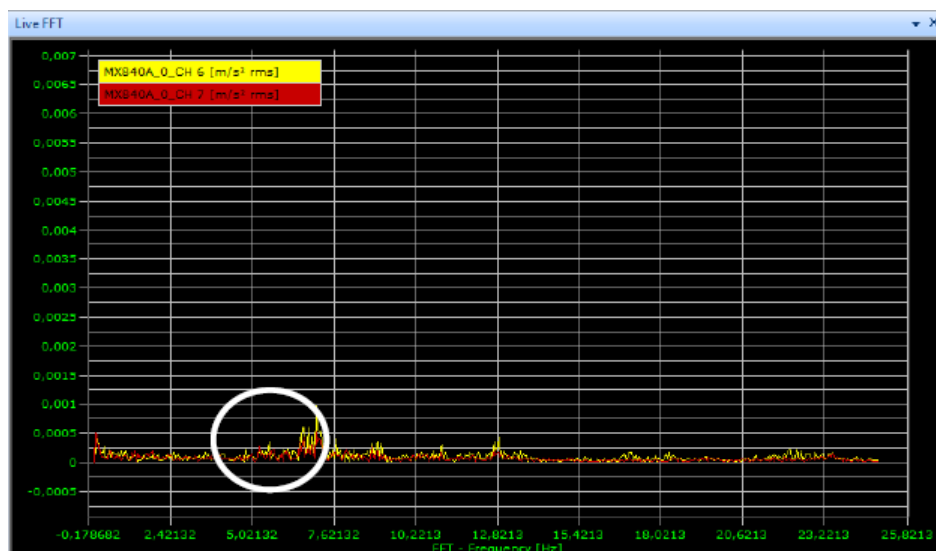
Figura 13: Terceiro ponto - Valores de frequência - Acelerômetros 6 e 7 - Sem vazamento associado
