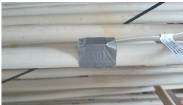
Figura 1: Acelerômetro fixado à tubulação
