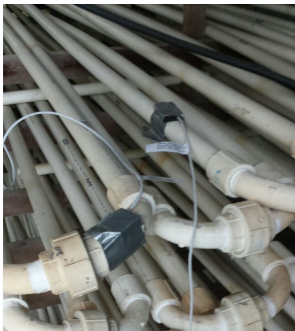
Figura 16: Esquema de posicionamento dos acelerômetros nas condições fixo - livre e curvatura em U
