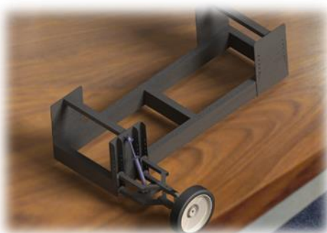
Figura 1. Chassi com 1/4 da suspensão duplo A em CAD
