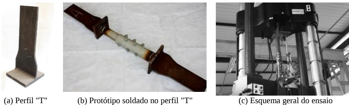
Figura 2. Esquema geral da fixação dos tubos na máquina de ensaio
