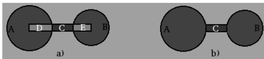
Figura 11 - Dois vugs unidos por uma fratura (a) antes das operações Cut, (b) após as operações Cut.
