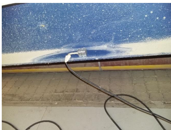
Fotografia 2: Fixação do acelerômetro resistivo
