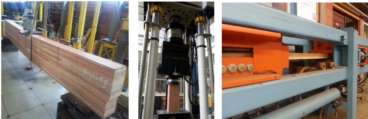
Figura 1: Ensaios a temperatura ambiente: (a) flexão; (b) compressão; (c) tração.
