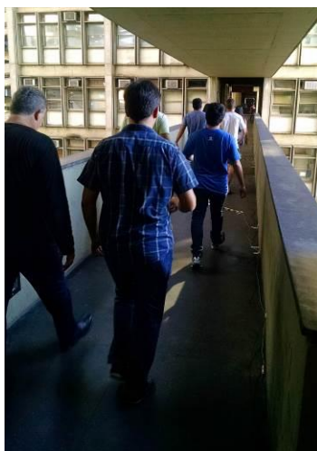
Figura 25. Teste experimental com pedestres caminhando ( f=2,0 \text{ Hz} : caminhada normal)
