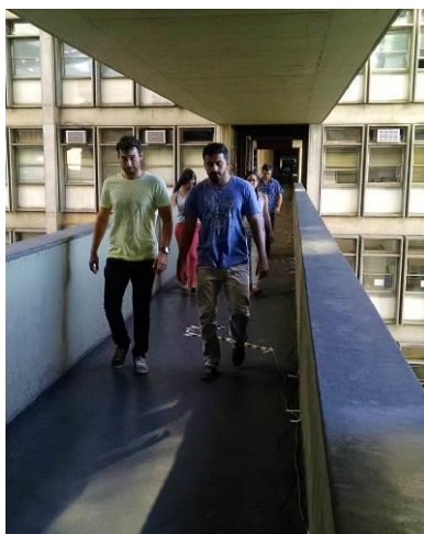
Figura 22. Teste experimental com pedestres caminhando ( f=1,7 Hz: caminhada lenta)
