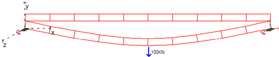
Figura 8. Deformada considerando interação livre na direção y
