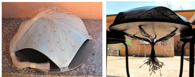
Figura 5. Modelos reduzidos para obtenção dos coeficientes de pressão internos e externos
