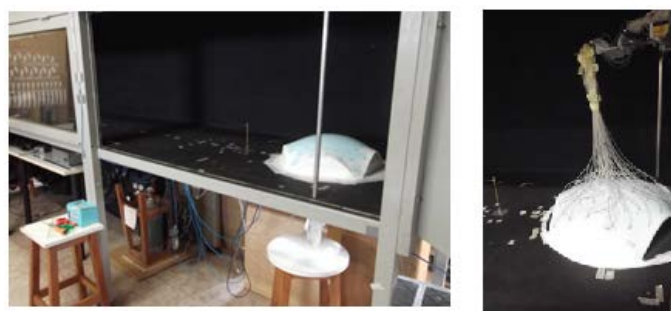
Figura 6. Modelos posicionadas para os ensaios no túnel de vento do LaCAF
