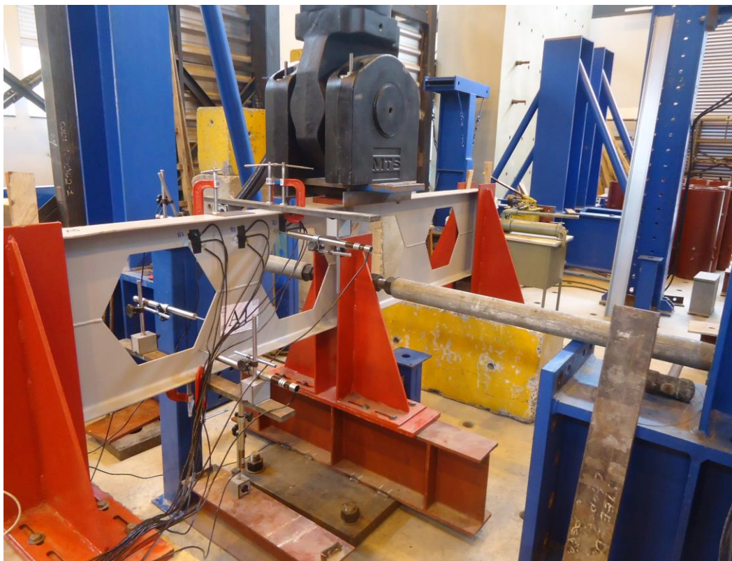
Figura 7. Montagem padrão dos ensaios.
