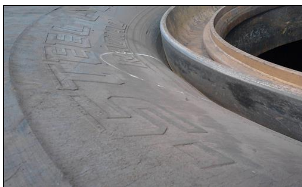
Figura 2. Separação entre a borracha e carcaça na parede lateral de um pneu: Pesquisa de Campo
