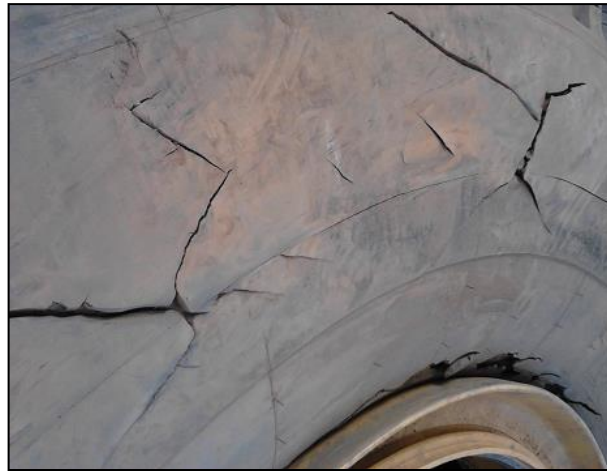
Figura 3. Trincas na parede lateral e erosões na região de assentamento do talão: Pesquisa de Campo
