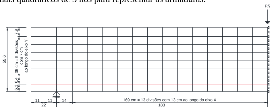
Figura 11 – Malha que representa a viga OA1
