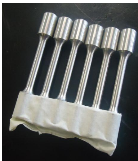
Figura 3 - Corpos de prova antes do ensaio, segmento usinado do produto
