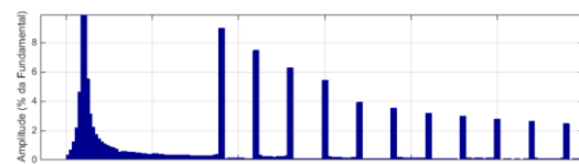
Fig. 19. Espectro harmônico da corrente de entrada com compensação de 3ª, 5ª e 7ª ordem
