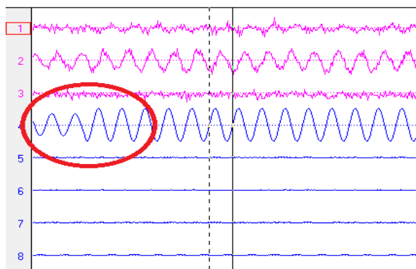
Fig. 7. Oscilografia da correção do Afundamento de Tensão.
