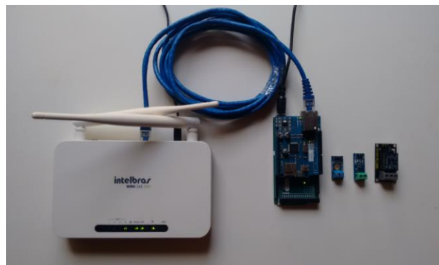
Fig. 6. Componentes requeridos para o SCADAWEB Hydrogen .
