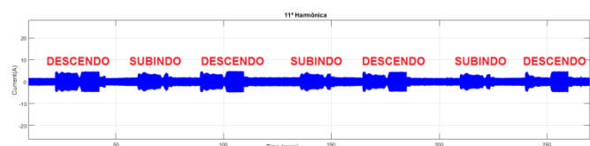
Fig. 18. Identificação dos eventos de subida e descida do elevador utilizando a 11ª harmônica.
