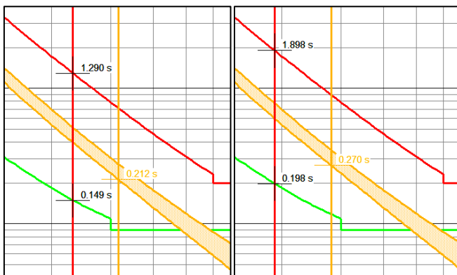
Fig. 11. Coordenação entre as barras 860-840 (religador-fusível) após curto-circuito trifásico (esquerda) e monofásico (direita) na barra 840
