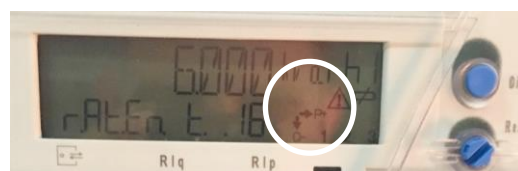
Fig. 10. Medidor para fins de faturamento utilizado pelas distribuidoras Actaris SL7000, indicando potência reativa com características capacitivas, como mostra o vetor apontando para baixo.
