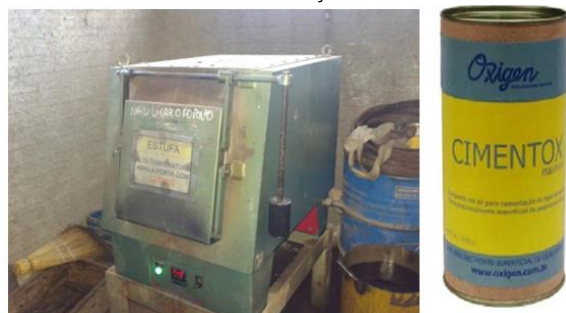
Figura 1. Forno de tratamento térmico e material para cementação.
