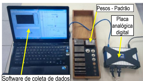
Figura 7 – Equipamentos utilizados na calibração do tribômetro bancada em rampa.
