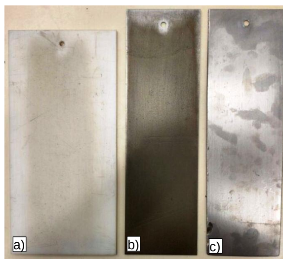
Figura 6. Corpos de prova após os ensaios: a) polímero UHMW, b) aço DIN S700MC, c) aço inoxidável AISI 304L.
