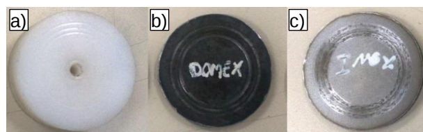
Figura 5. Corpos de prova após os ensaios: a) polímero UHMW, b) aço DIN S700MC, c) aço inoxidável AISI 304L.
