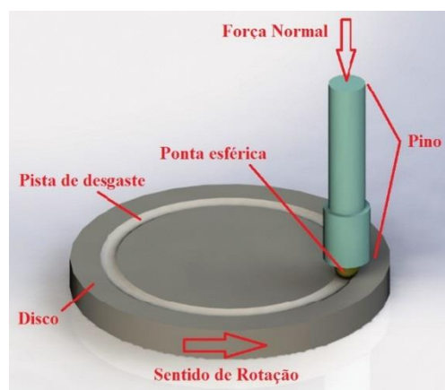
Figura 8. Princípio de funcionamento de um tribômetro do tipo pino sobre disco.
