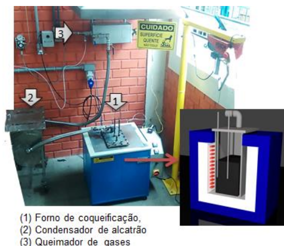
Figura 1 - Forno de coqueificação em escala de laboratório.
