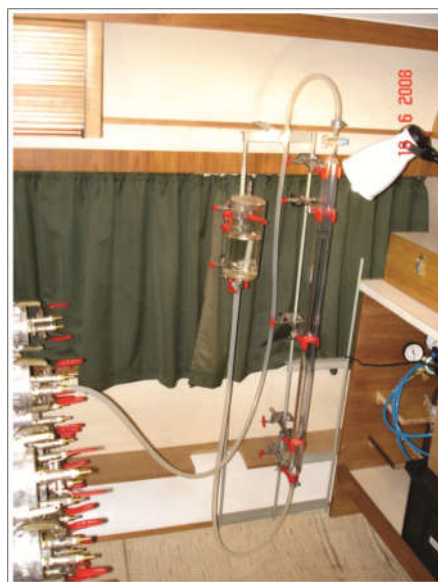
Figura 3. Coluna de vidro graduada para medição do volume de gás dessorvido.
