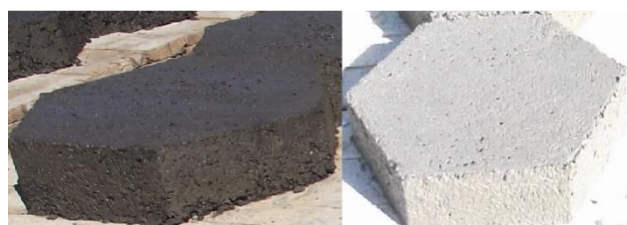
Figura 8: Bloco de concreto com 100% e 0% de rejeito de carvão, respectivamente
