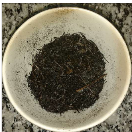
Fotografia 1 – Bambu moído e torreficado a 275°C
