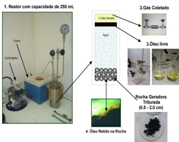
Figura 3 - Reator de hidropirólise (250 ml) e esquema do procedimento para análise das frações obtidas nos ensaios.
