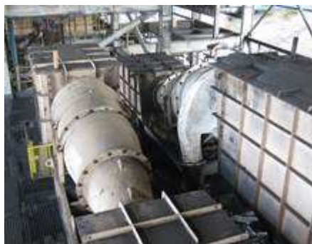
Figura 2 - A figura ilustra ciclones de meio denso da Vale-Moatize de onde foram colhidas as amostras.
