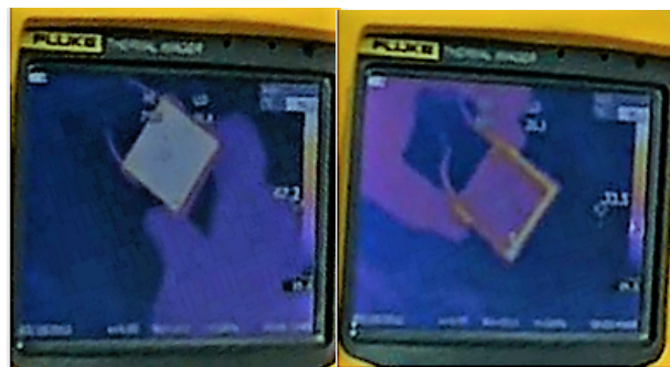
(a) Peltier com face quente. (b) Peltier com face fria.
