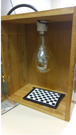
Figura 2: Configuração utilizada para realizar a calibração da câmera térmica.
