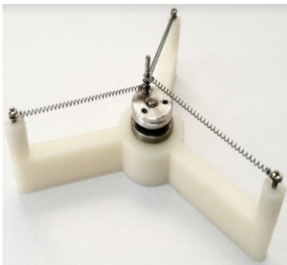
Figura 2. Motor com atuadores tipo mola helicoidal de NiTi.
