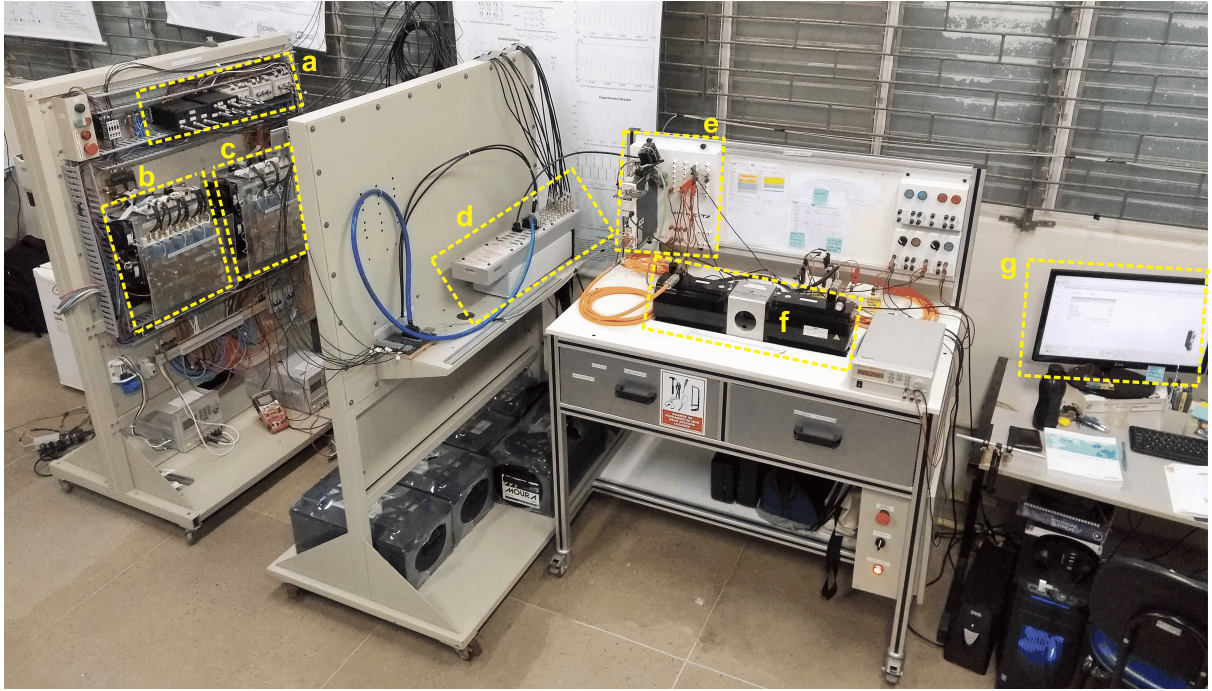
Figura 3: Plataforma experimental. a) Sensores de tensão e corrente; b) Inversor; c) Retificador controlado; d) Dspace DS1103; e) Servo controlador; f) Conjunto motor/gerador PMSM; g) PC/supervísório.
