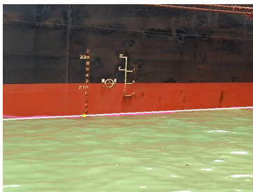
Figura 10: Imagem com marcação da linha d'água e marca de calado exemplo.
