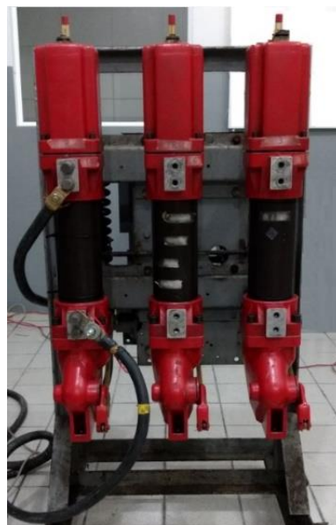
Figura 3. Fotografia do disjuntor utilizado em laboratório.
