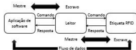
Figura 2. Fluxo de dados e comunicação mestre-escravo.
