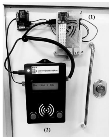
Figura 4. Protótipo do sistema de controle de acesso
