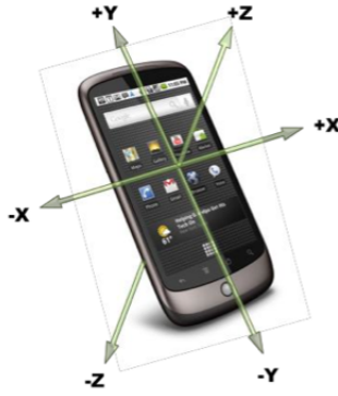
Figura 2: Sistema de eixos do smartphone .
