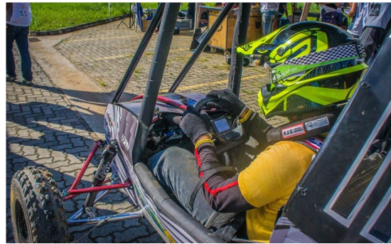
Figura 3: Exibição das informações ao piloto através de um Display TFT.
