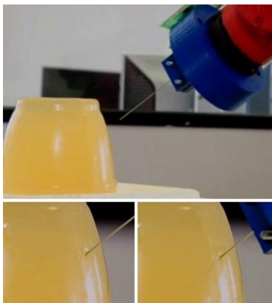
Figura 7. Sequência de agulhamento de corpo de prova de gelatina
