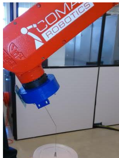
Figura 5. Calibração da ferramenta de acoplamento da agulha à flange do robô
