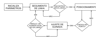
Figura 4: Fluxograma adotado para o cumprimento da tarefa de seguimento de linha.
