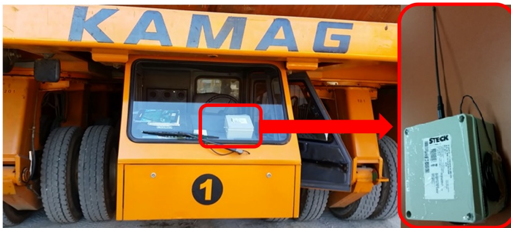
Figura 2: À esquerda: imagem da cabine do motorista com o protótipo, à direita: encapsulamento do protótipo desenvolvido com as antenas RFID e GPS em evidência.
