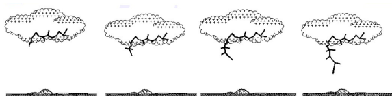
Figura 1. Etapas na formação de uma descarga atmosférica (VISACRO, 2007).
