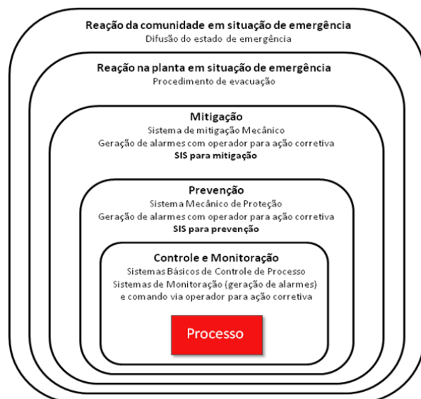
Figura 1. Camadas de redução de riscos (adaptado da IEC 61511-1).
