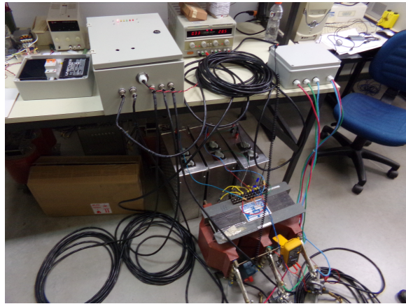
Figura 9: Foto de ensaio realizado no laboratório com transformador de 3,5 kVA 220 V - 11 V
