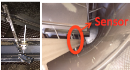
Figura 4: Sensor de temperatura PT100 no café, e outro lado da chapa de revolvimento do secador
