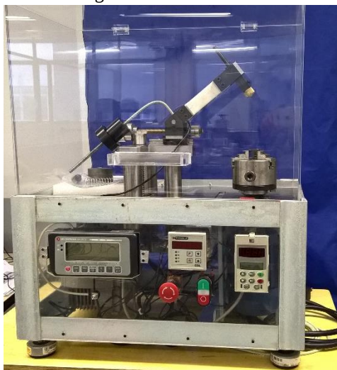
Figura 3. Equipamento de ensaio tribológico.
