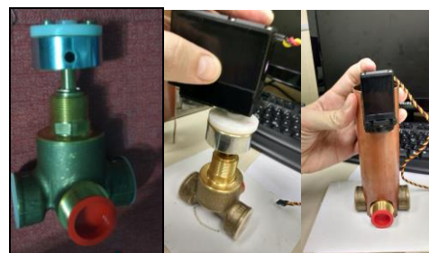
Figura 11. (A) Misturador, (B) servo motor acoplado ao misturador e (C) conjunto após montagem
