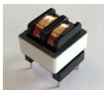
Figura 9. Indutor modo comum com núcleo de ferrite E13 construído
