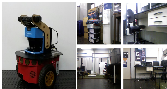
Figura 8: Robô Pioneer 3DX com câmera RGB-D embarcada e amostra das 565 imagens capturadas em um ambiente indoor .
