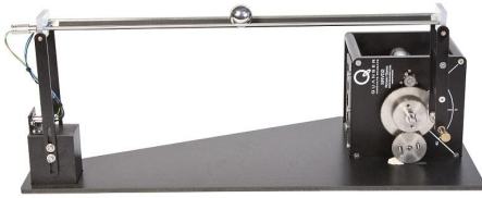
Figura 1: Sistema barra e bola. Fonte: Site do fabricante.
