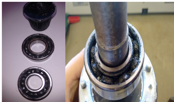
Figura 2: Contaminação do rolamento dianteiro com pasta abrasiva
