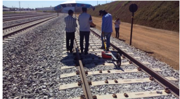
Figura 3. Fotografia evidenciando a aquisição de dados de GPR com o sistema SIR3000 acoplado a uma antena blindada de 900MHz.
