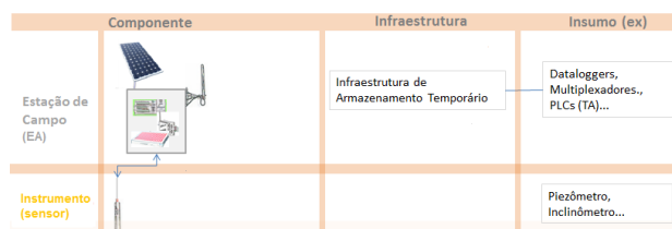
Figura 1. Componentes para a automação de piezômetros. Fonte: VALE (2014).
